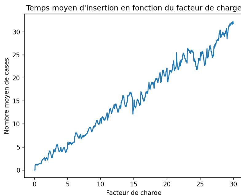
Cette courbe semble être en  $O(1 + \alpha)$ . Pour la comparer à ce qu'on aurait dans le pire des cas, on va refaire la même mesure mais sur un jeu de donné qui ne contient que des doublons (pour forcer les collisions).
